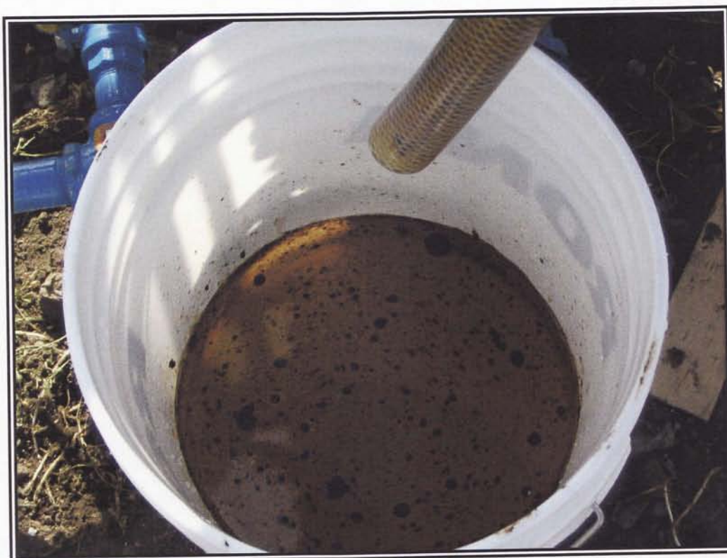
Photo no 4 : Hydrocarbures récupérés en fin de traitement
